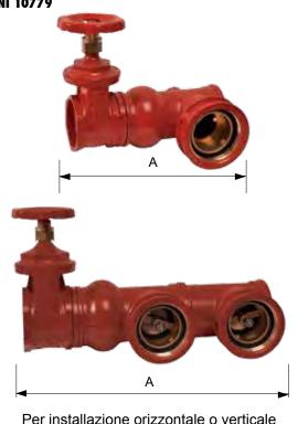
L'attacco di mandata per autopompa a norma UNI 10779 è un dispositivo installato in derivazione dall'anello idrico della rete antincendio per mezzo del quale tramite l'autobotte dei vigili del fuoco può essere immessa dell'acqua in situazioni di emergenza.
