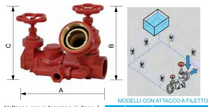
L'attacco per autopompa in linea è un dispositivo collegato da una parte all'impianto di alimentazione idrica e dall'altra alla rete idrica antincendio per mezzo del quale può essere immessa dell'acqua in situazioni di emergenza
