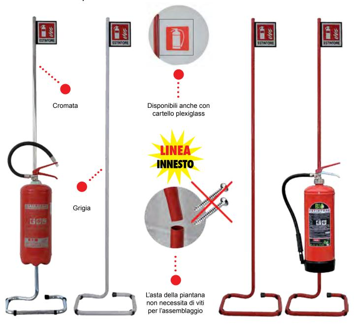
Porta estintori dalla linea semplice ma allo stesso tempo elegante costruiti in tubolare di acciaio piegato e rastremato con piegatrici automatiche, accuratamente verniciati con polveri epossidiche in colore ROSSO o GRIGIO. La semplicità di montaggio, che non necessita l'utilizzo di viti, permette di velocizzare il tempo di installazione. L'ampia base garantisce stabilità anche con estintori con massa elevata.
