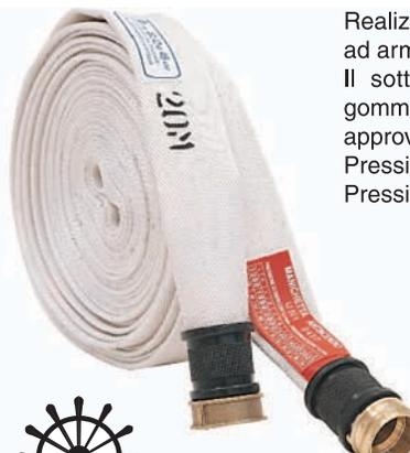
Realizzata in tessuto circolare ad armatura diagonale. Il sottostrato è realizzato in gomma sintetica EPDM, ed è approvata MED
