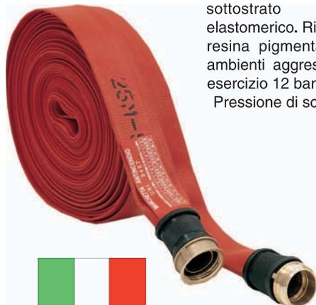
Realizzata in tessuto poliestere con sottostrato impermeabilizzante elastomerico. Rivestimento esterno in resina pigmentata adatta all'uso in ambienti aggressivi. Pressione di esercizio 12 bar
